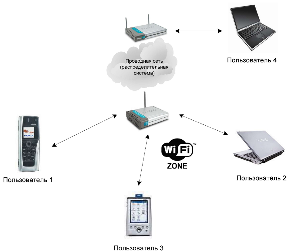
Рис. 3.7. Расширенная зона обслуживания ESS беспроводной локальной сети
