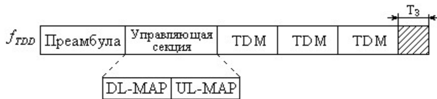
Рис. 3.20. Структура нисходящего канала.
